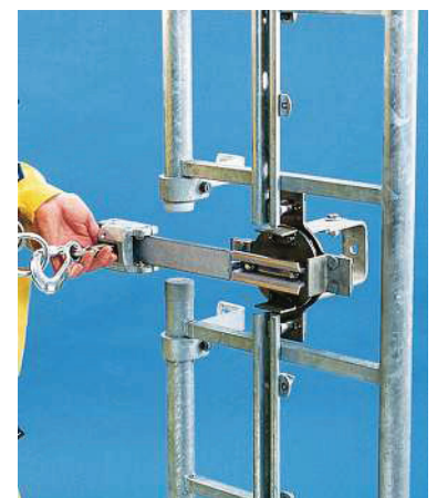
Weiche Typ 0929.46. Waagrechte Fallschutzschiene, (hier einseitig links) über eine Weiche mit lotrechter Fallschutzschiene verbunden
